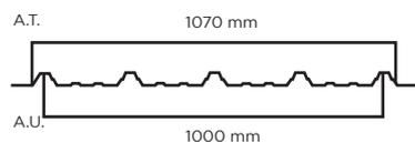
Panel termoacústico multicapa Klar de 1.5mm de espesor con cinco crestas y una altura de 35.00mm. Diseño que permite desarrollar mayor inercia, facilidad de montaje, flexibilidad y una mejora en la canalización del drenaje debido a sus relieves menores reduciendo así la estanqueidad. Así mismo, en su forma contempla un extremo como corta gota a fin minimizar el ingreso de agua. También permite un radio de curvado de 12mts sin hacer uso de máquinas de rolado.
