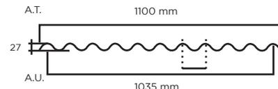
Panel termoacústico multicapa Klar de 1.5mm de espesor con once crestas y una altura de 27mm. Diseño que permite desarrollar mayor inercia, facilidad de montaje, flexibilidad y una mejora en la canalización del drenaje debido a sus relieves menores reduciendo así la estanqueidad. Así mismo, en su forma contempla un extremo como corta gota a fin minimizar el ingreso de agua. También permite un radio de curvado de 12mts sin hacer uso de máquinas de rolado.
