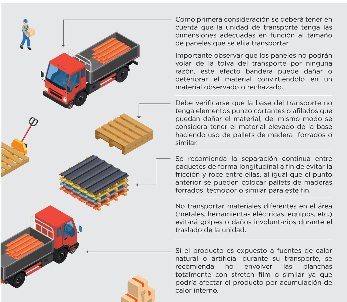
El diagrama ilustra el ciclo de transporte y manipuleo del material. Comienza con un trabajador cargando un camión con paneles. Luego, se muestra un pallet con paneles, un pallet con paneles y un pallet con paneles. Finalmente, se muestra un camión con paneles y un pallet con paneles.
